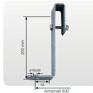
Maueranker starr Wandabstand 200 mm
